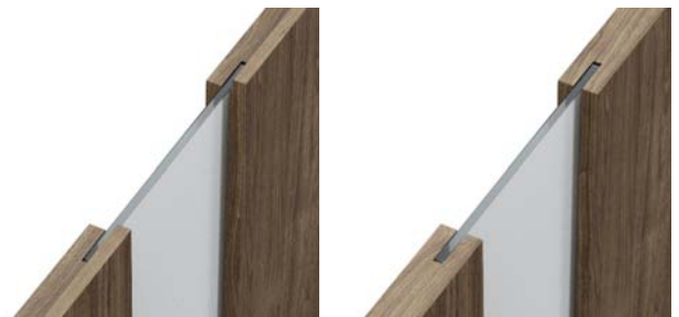
łączenie z szybą „na kant” skrzydło przylgowe
